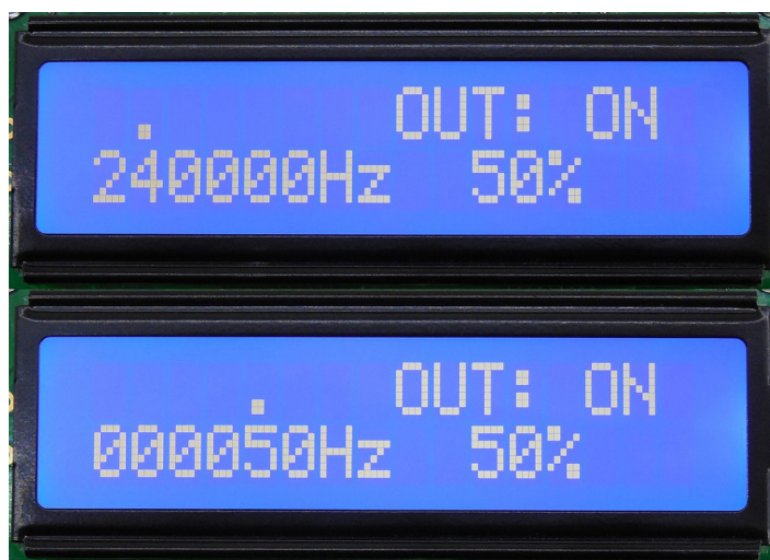
Fotografia 3. Zmiana częstotliwości z 240 kHz na 50 Hz
